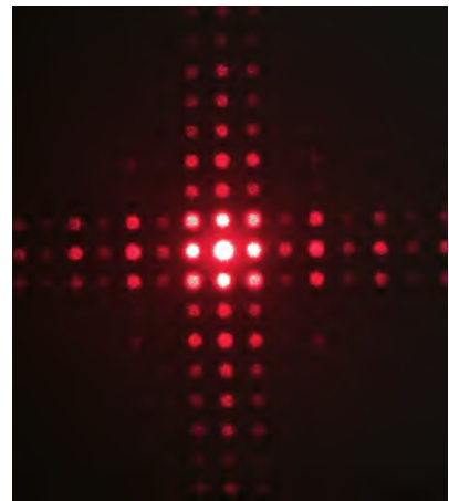
图 10: 二维光栅透射光在透镜变换后像平面上的像.
