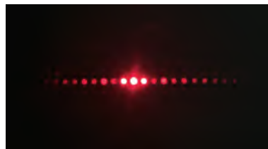
图 6: 一维光栅衍射在通过透镜后呈现为横向等间距的点，光强从 0 级衍射斑到两侧逐渐减小。
