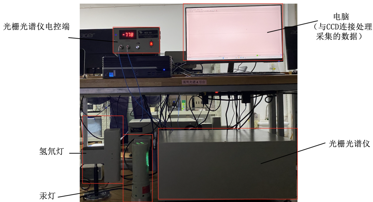
图 2: 实验装置正视图.
